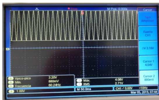
Fig. 4. Señal de salida del sensor con carga 2300W alimentada con AC.
